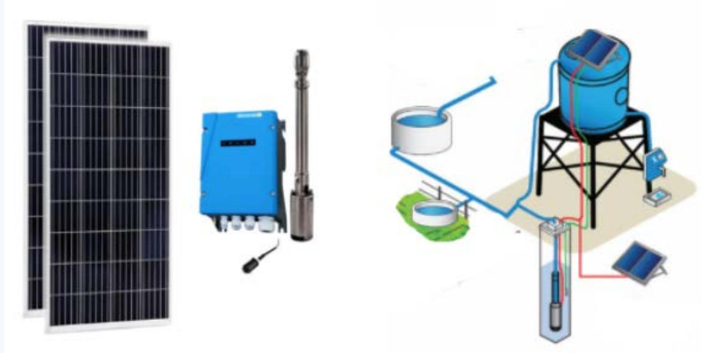
C'est le système de pompage qui alimentera les unités MUPEL à partir de l'eau du lac Nokoué. Il s'agit d'un système de pompage « au fil du soleil ». Il fonctionne en totale autonomie sans source d'énergie extérieure, sans batterie. La **pompe immergée 4"** peut être utilisée pour des forages, des puits ou toute autre source. Elle permet une hauteur de relevage jusqu'à 50 m et un débit jusqu'à 0,54 m<sup>3</sup>/h
